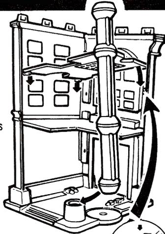
5. Säule in die abgebildete Öffnung stecken und die dritte Plattform an den Wänden befestigen.
